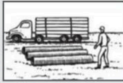
วางท่อนไม้ไว้ใต้ท่อ เพื่อไม่ให้ท่อกลิ้งเคลื่อนที่
