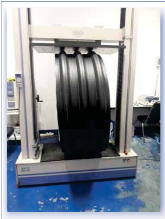
▶ Universal Testing Machine ทดสอบการรับแรงกดทับ
